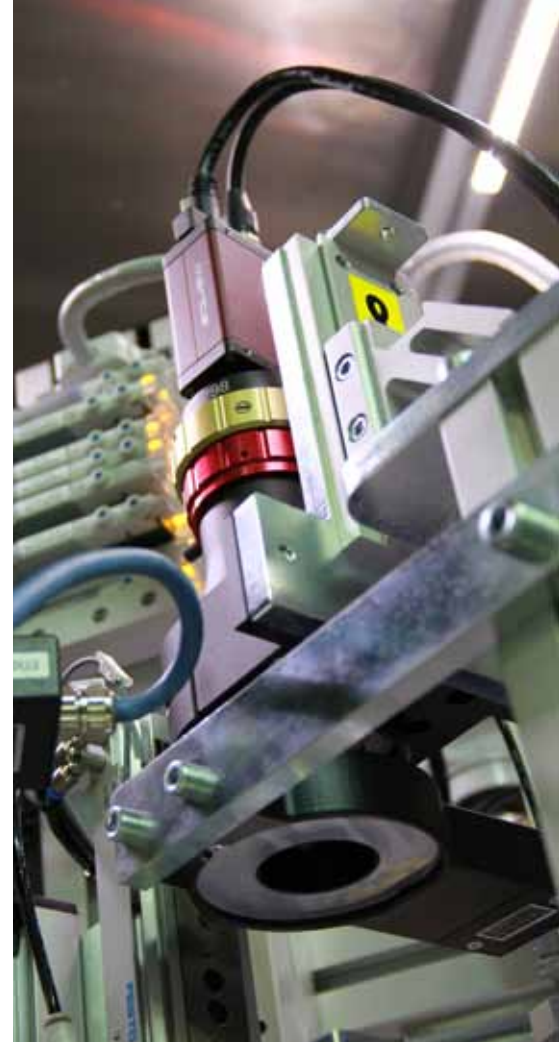
Kamera mit telezentrischem Objektiv und Aufsicht-Beleuchtung.
